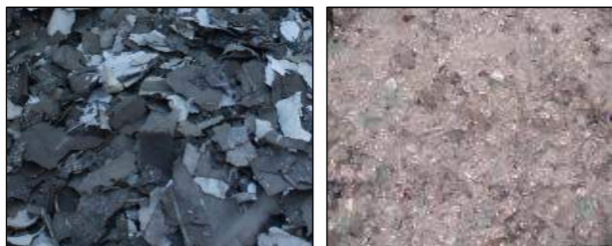
Figure 30 : Fragments de silicium et granulés de verre (Source : PV CYCLE, photovoltaïque.info)
